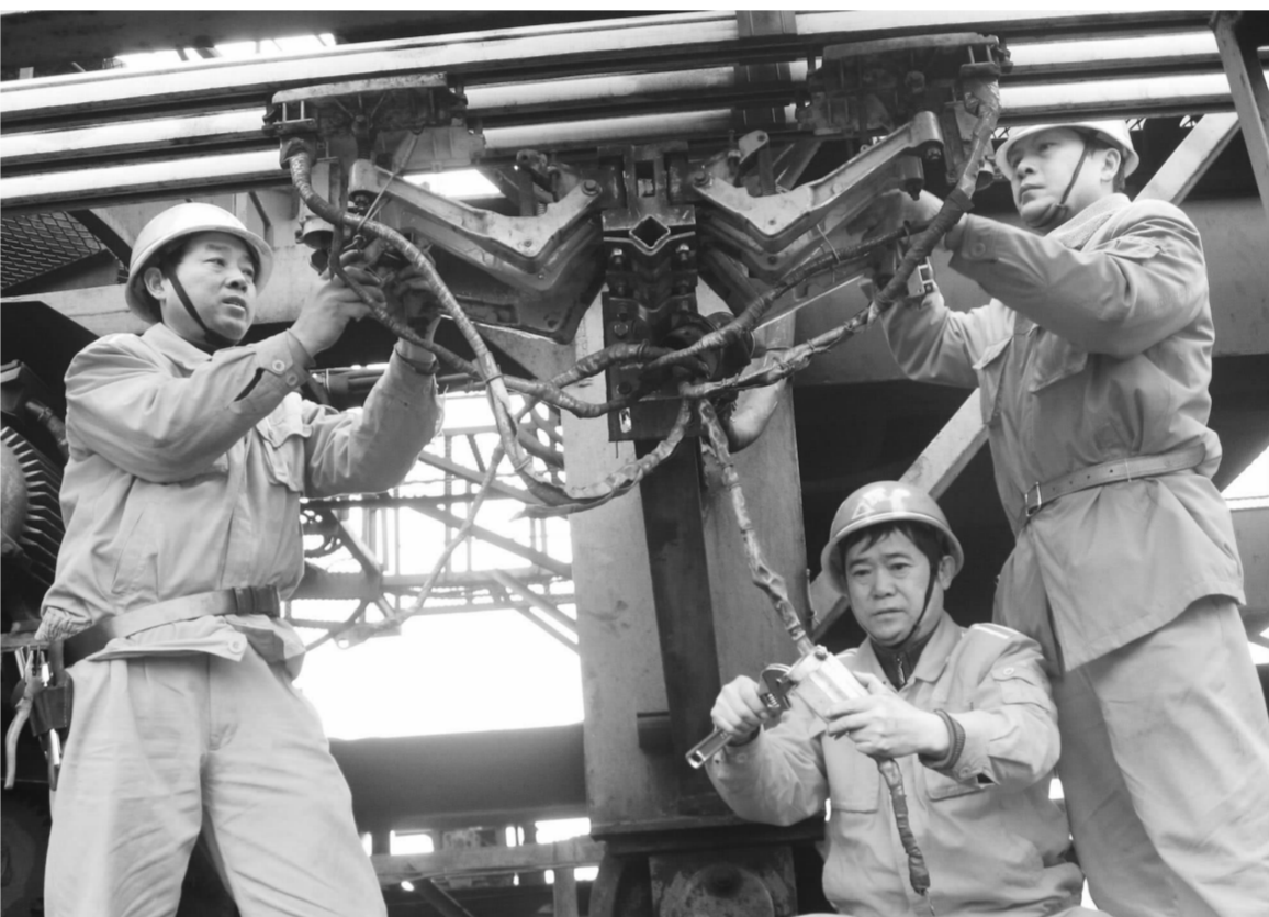
本报讯 日前,安徽芜湖港裕溪口煤码头分公司电动维修工对煤运设备滑触线电器进行养护。随着春节的临近,皖江、长三角各电厂积极储备节日电煤,为此,芜湖港通过勤保养大煤运设备设施,加大煤码头电煤中转力度,以满足电厂节日期间发电用煤需求。(郑永星/摄影报道)
