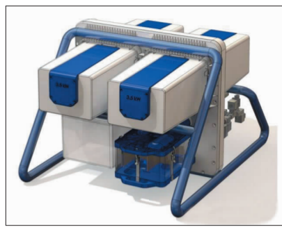
一台 Waste2Tricity 设备可以用来对碳垃圾进行分类,并将垃圾转化为电力。这些垃圾被放进一个等离子体气化舱,通过超高温转变成合成气。这个过程要优于焚化,因为它产生的污染性气体、焦油、灰渣和粉尘比后者要少。它的主要副产品是玻璃状熔渣,可用于道路建设。(图片提供:Waste2Tricity)
