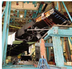
波音公司的787梦想飞机机翼翼盒的复合材料在压力测试中出现了问题。
