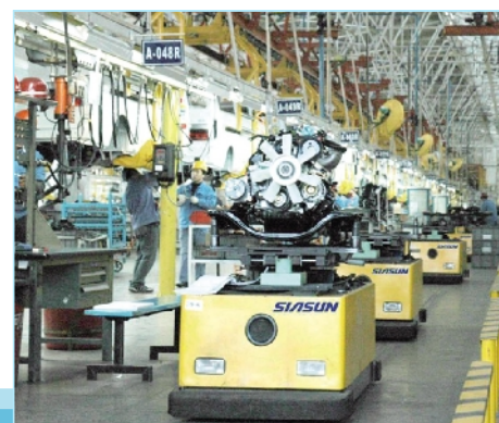
新松公司研发的AGV在工厂应用。
