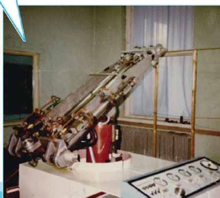
1982年6月19日，我国第一台应用计算机实现点位控制和速度轨迹控制的示教再现型工业机器人研制成功。
