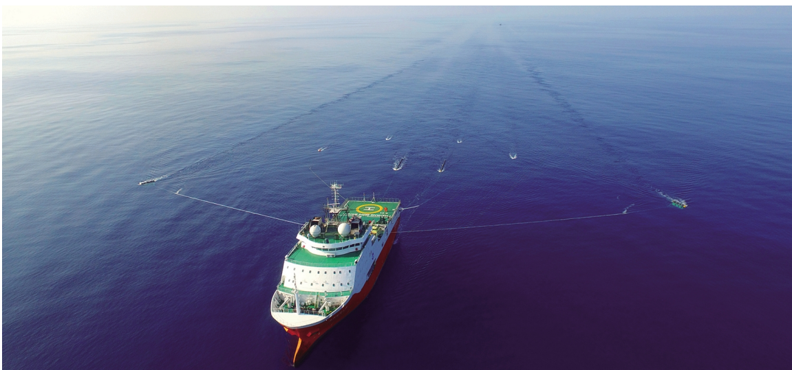
记者从广州海洋地质调查局获悉,由该局牵头承担的国家重点研发计划“战略性国际科技创新合作”重点专项项目——“天然气水合物勘查开发技术联合研究”取得实质性进展,近日已完成高精度小三维地震采集系统研发并通过海试验收。依托“海洋地质八号”船,高精度小三维地震采集系统在我国南海海域完成了海试验收,并成功在南海北部海域水合物目标区进行了示范应用。图为高精度小三维地震采集系统依托“海洋地质八号”船进行海试。 本报记者朱汉斌报道 任颖芝供图
