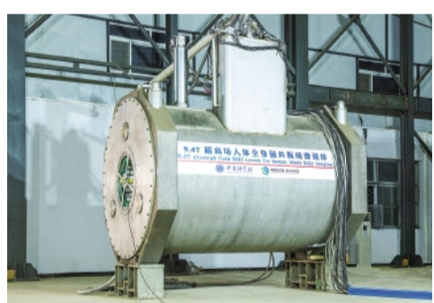
9.4T 超高场人体全身磁共振成像超导磁体。中科院电工研究所供图
