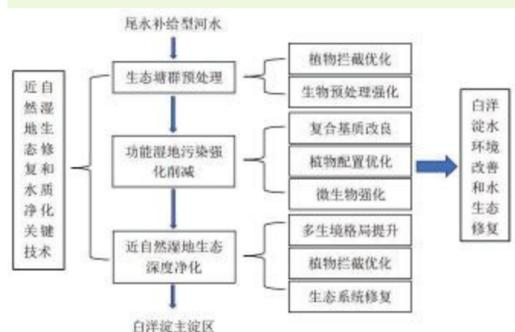
图2 近自然湿地生态修复和水质净化关键技术流程图
