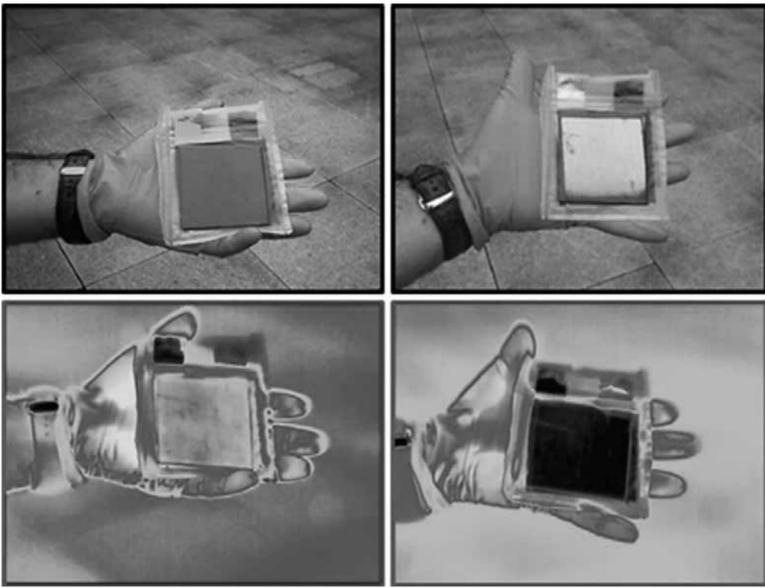
显示屏在可见光下处于未充电状态(左上)和充电状态(右上)。屏幕在未充电时(左下)反射一段红外波长，在充电时(右下)反射另一段红外波长。
