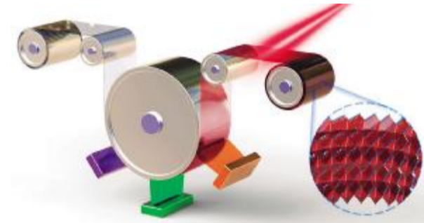
真空沉积钙钛矿薄膜示意图。中科院大连化学物理研究所供图
