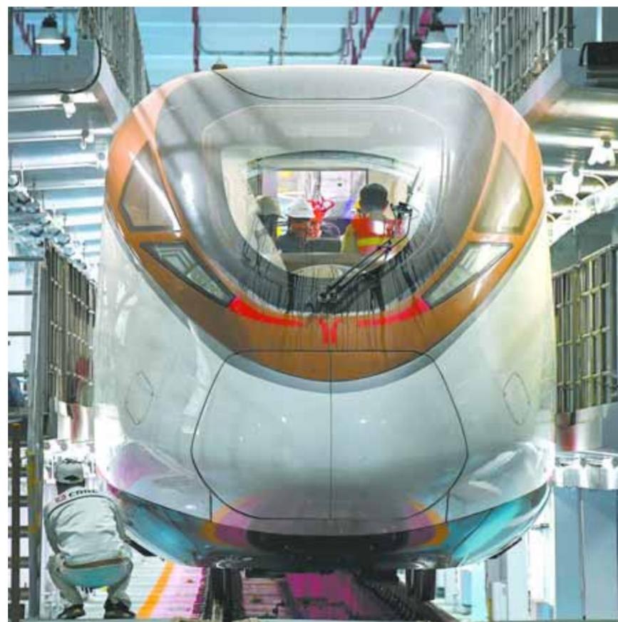
3月3日凌晨,广州地铁18号线时速160公里电客车在横番3号风井至番禺广场站段进行全线首次热滑试验,以对该线地铁供电、信号、通信、线路、机电等系统设备进行全面检测。
