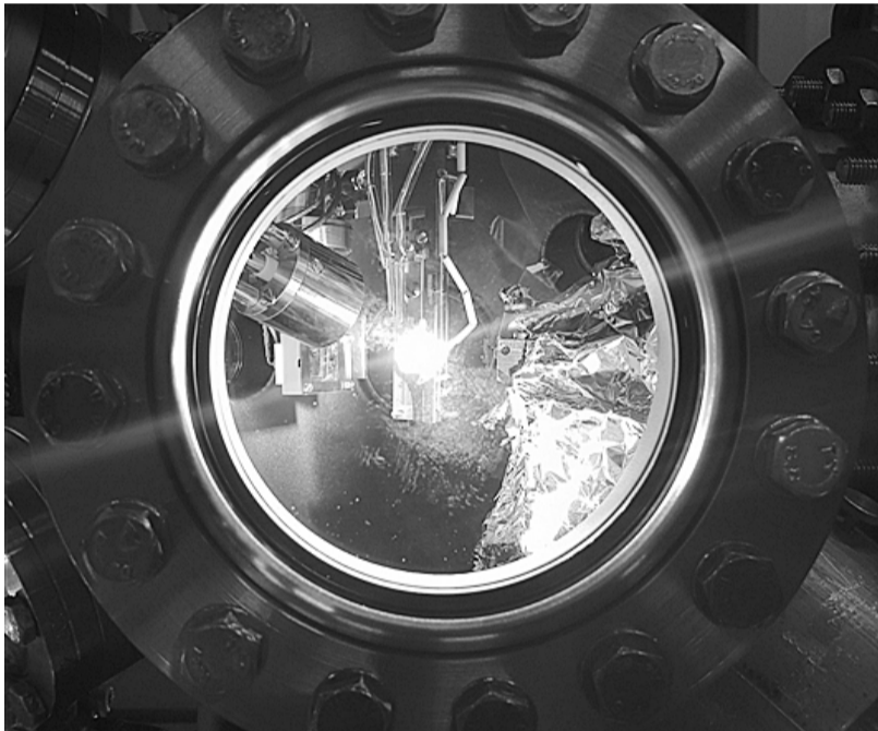
测量过程中使样品保持恒定温度的发光灯丝。 图片来源:HZB
