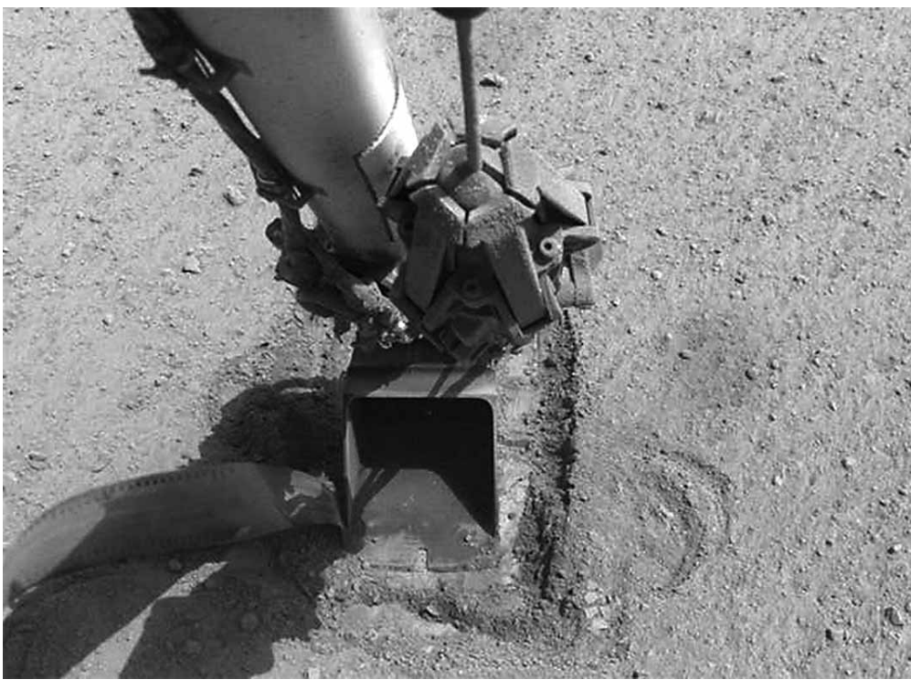
“洞察”号着陆器的热探测器,也被称为“鼯鼠”,无法在火星表面钻洞。图片来源:NASA/JPL-Caltech
