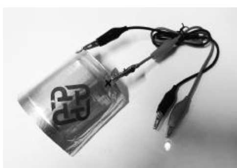
基于柔性织物复合电极制备的柔性锂电池在弯曲状态下仍能稳定供电。 香港理工大学郑子剑课题组供图
