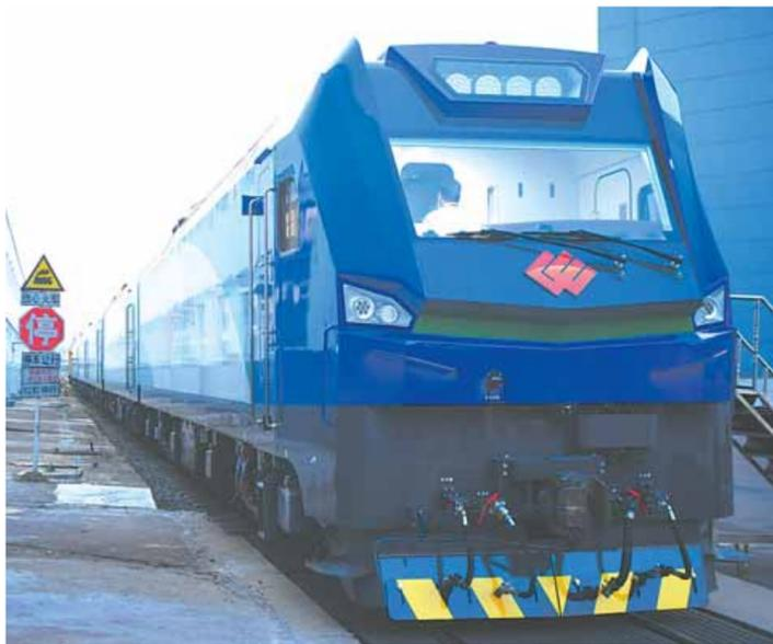
7月29日,单机功率28800千瓦、牵引力2280千牛的“神24”电力机车在中车株洲电力机车有限公司下线。这一超大功率电力机车的成功研制,标志着中国铁路重载技术创新取得重大突破。
