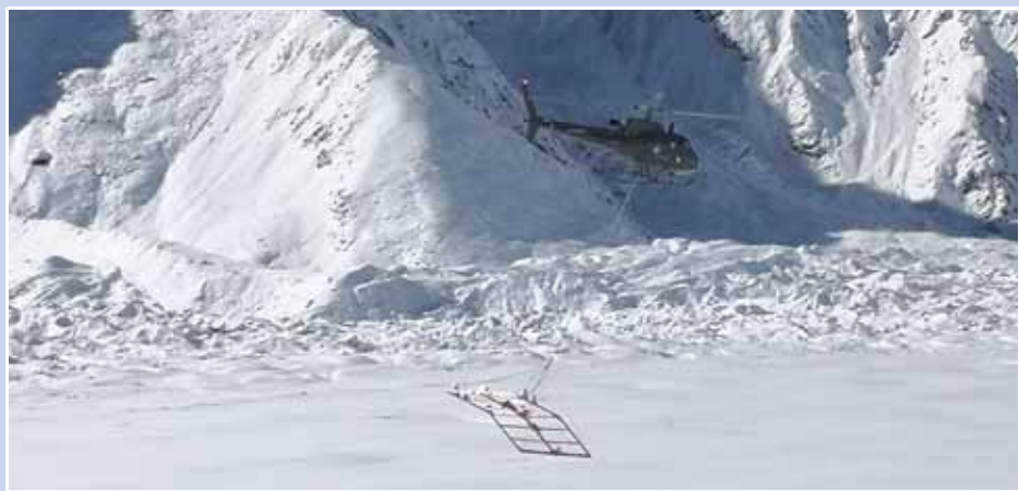
首次采用直升机载雷达给冰川测厚。
