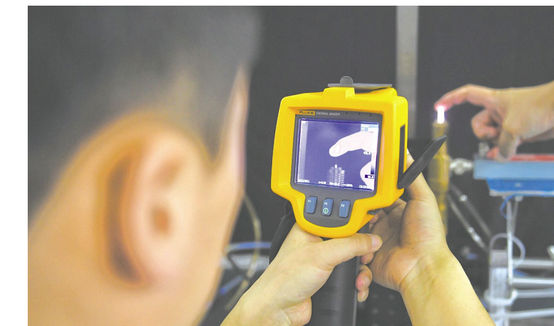
近日,电子科技大学研究人员研发新型手持红外热像仪,图为利用仪器检测等离子体射流对人体皮肤作用的效果。研究人员采用微波激发等离子体,通过特殊结构,使低温等离子体射流在没有约束管道的条件下,可以稳定地在大气中存在,射流长度超过2厘米。这大大拓展了低温等离子体射流的应用场景。 新华社记者刘坤攝
