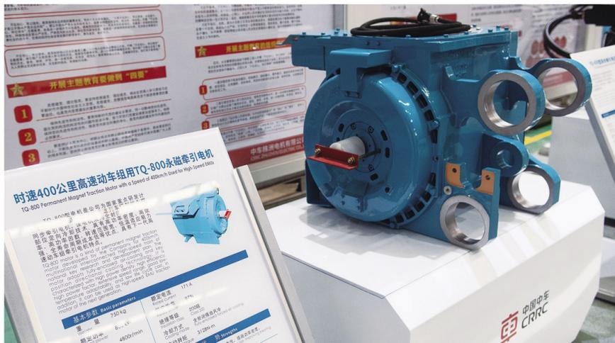
9 月 17 日，中车株洲电机公司发布了时速 400 公里高速动车组用 TQ-800 永磁牵引电机（如图）。这标志着我国高速动车组首次搭建起时速 400 公里速度等级的永磁牵引电机产品技术平台，填补了国内技术空白，为我国轨道交通牵引技术升级换代奠定了坚实基础。新华社发（陈思汗摄）
