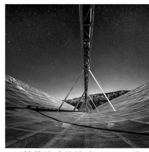
随着地球的转动,CHIME的凹槽扫过天空,捕捉到短暂的无线电磁脉冲,并将信号集中到顶部的天线上。图片来源:ANDRE RENARD
