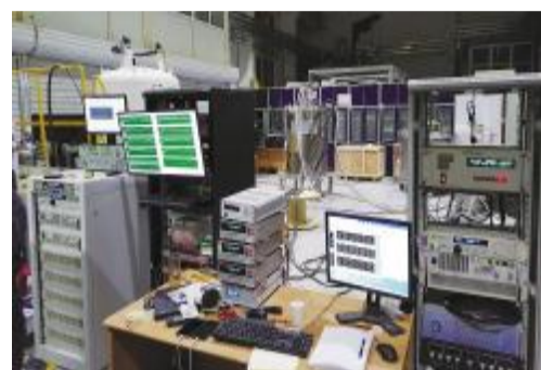
正在实验室测试的高磁场全超导磁体(位于液氦罐体中) 中科院电工所供图
