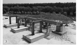
通过分析模型上百个测点得到的数据,团队总结提出适用于C型柱体系的承载力计算方法,并最终验证新机场航站楼屋盖钢结构设计能够满足8度罕遇地震的抗震要求。
