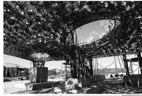
①进行竖向承载性能试验和拟静力水平往复加载试验
