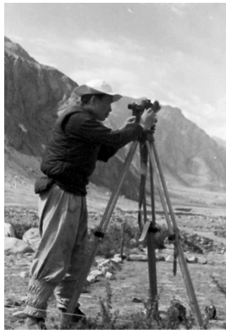
作者在天山托木尔峰破城子观测站用测风经纬仪观测风随高度变化。高登义供图
