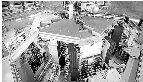
这个超导回旋加速器在日本和光市理化研究所的放射性同位素束装置中产生了奇异的核子束。图片来源:RIKEN
