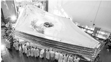
测试在詹姆斯·韦伯太空望远镜遮阳板的薄织物上产生了小水滴。
