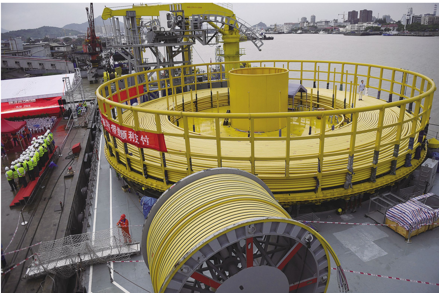
6月20日,装载有首根国产化海洋脐带缆的数艘船停泊在宁波市北仑区东方电缆码头。当日,由我国自主研发、设计、制造的首根国产化海洋脐带缆在浙江省宁波市北仑区东方电缆码头交付,即将安装应用于海洋深水油气田群开发项目。此脐带缆设计应用水深500米,总长23.047千米,总重超700吨。 新华社记者黄宗治摄
