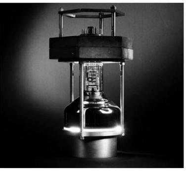
便携式中微子探测器的原型，它首次探测到中微子的相关散射过程。
