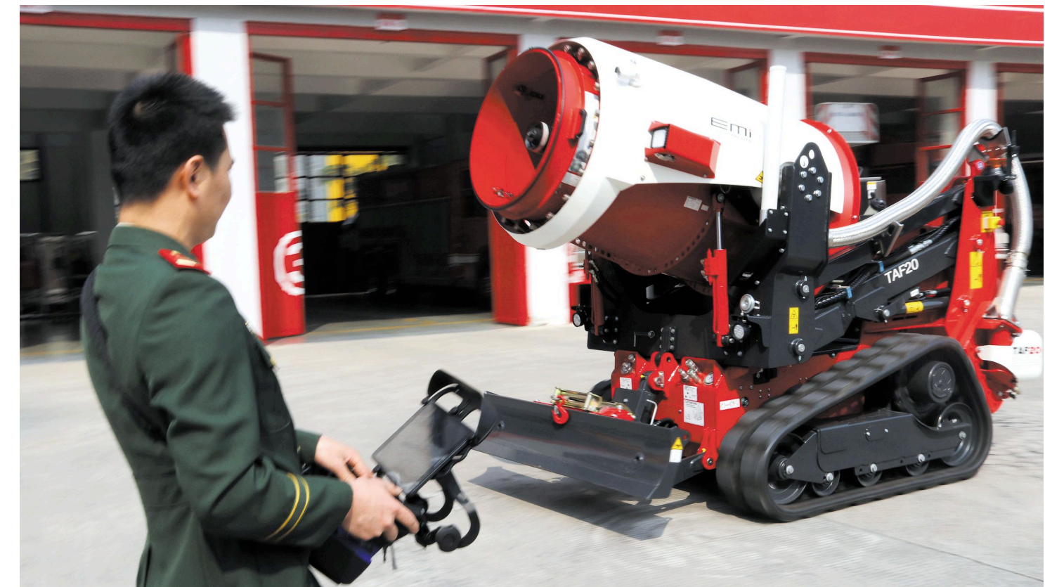
3月21日,福建省厦门市消防支队特勤大队队员在演示操作多功能消防灭火机器人。日前,一台多功能消防灭火机器人在厦门消防支队特勤大队正式投入使用。该款机器人可无线遥控操作,具有灭火、排烟、探测、破拆、摄像等功能,可应用于石油化工、机场、隧道等各种类型火灾处置。在面对高温、有毒气体泄漏等危急时,机器人可在遥控操作下代替消防官兵靠近灭火。新华社发(曾德猛摄)
