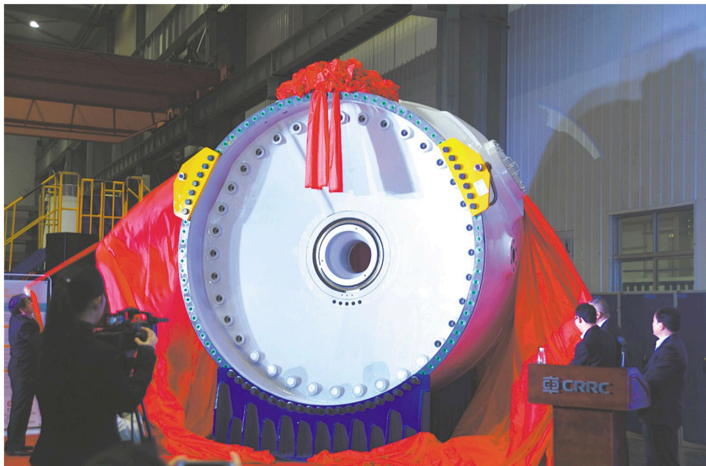
1月16日,中车株洲电机公司为6兆瓦半直驱永磁风力发电机举行下线仪式。这是我国拥有自主知识产权的首台最大功率半直驱永磁风力发电机。该款风力发电机采用先进的电磁方案结构设计与通风冷却设计,具有效率高、噪音低、抗电磁能力强、体积小、重量轻、防盐雾腐蚀能力强等优势,并成功实现了与齿轮箱高度集成化。 新华社记者龙弘涛摄
