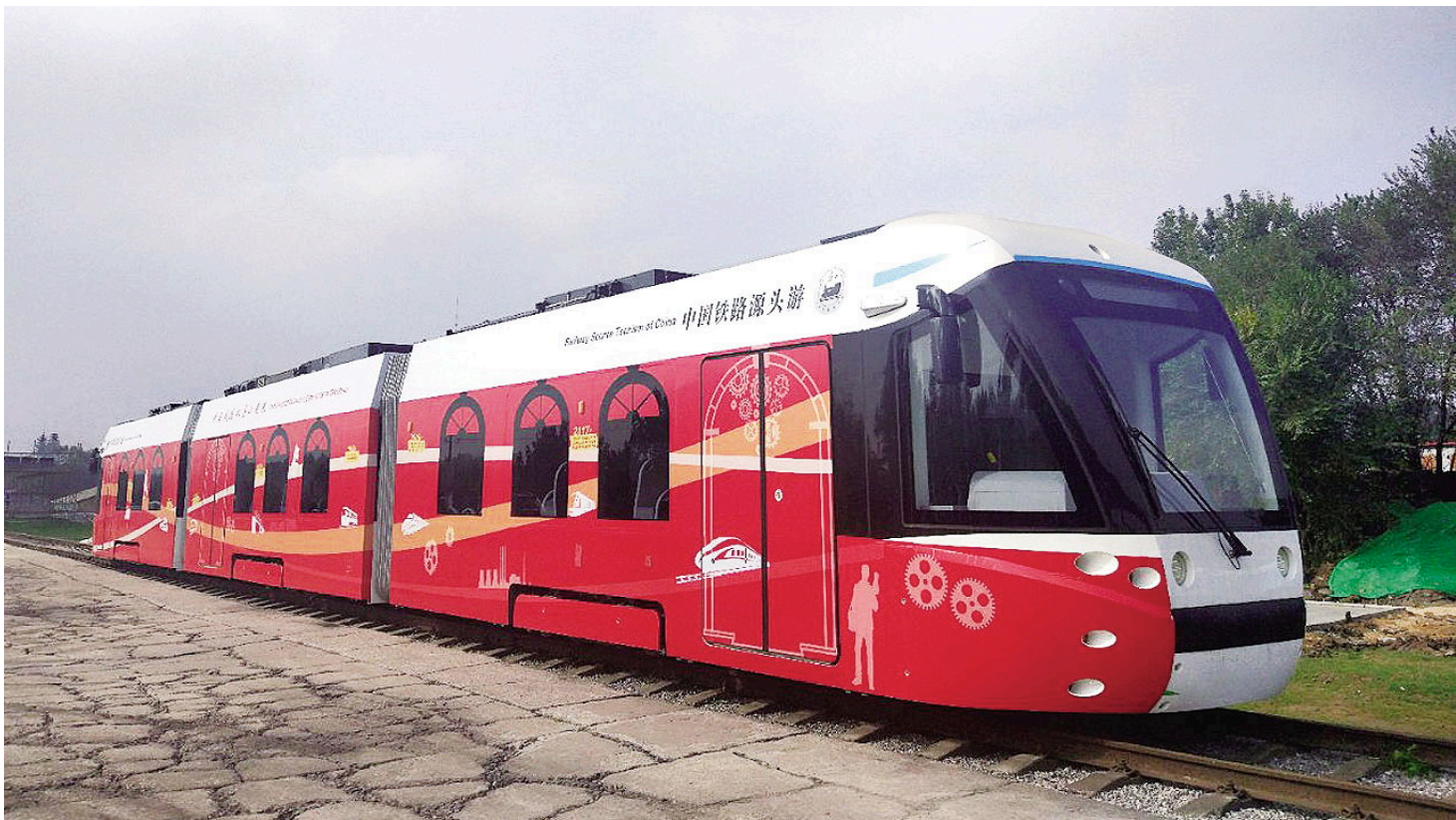
近日,世界首列商用型氢燃料混合动力有轨电车在具有136年历史的唐胥铁路载客运营。这是全球范围内燃料电池有轨电车首次商业运营,标志着我国在新能源轨道交通领域实现重大突破。经过4年多攻关,中车唐山公司在全球首次突破了燃料电池/超级电容混合动力牵引和控制等一系列关键技术,研制的有轨电车完全取消受电弓和接触网,填补了该领域空白,实现污染物“零排放”和全程“无网”运行。本报记者高长安 通讯员吴可超、何经纬摄影报道
