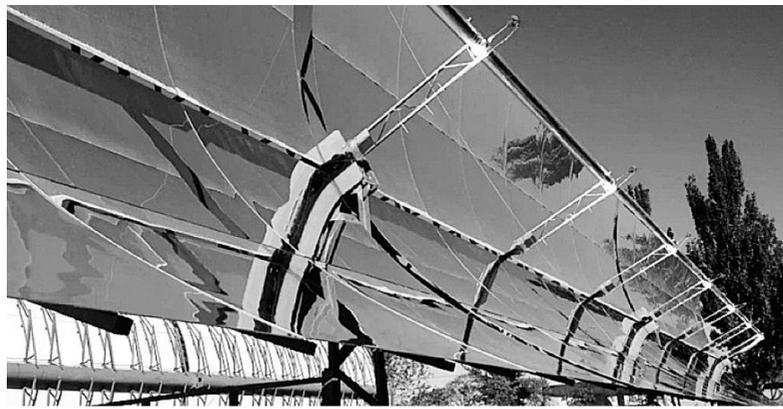
太阳能热发电实验台
