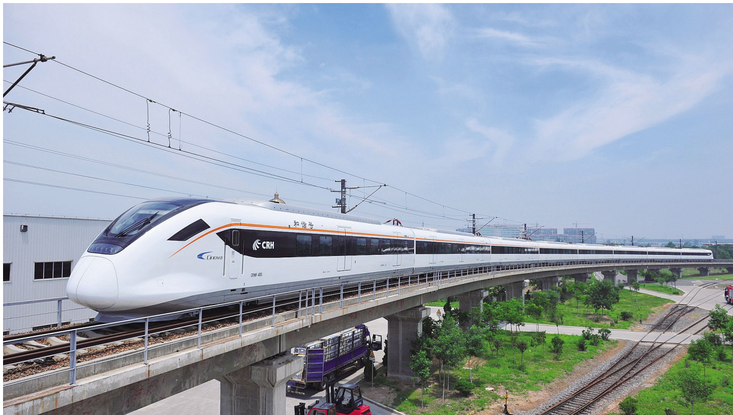
由中车青岛四方机车车辆股份有限公司研制的我国首款时速160千米CRH6F型城际动车组,近日获得国家铁路局颁发的型号合格证和制造许可证。这标志着CRH6F具备了批量生产和正式上线载客运营的条件,将为我国城际交通网络和打造1小时“都市圈”再添新利器。CRH6F是目前我国载客量最大的城际动车组,8节编组时最多可载客2000人,以3分钟为发车间隔,小时输送能力达4万人,堪称“最能装”的动车组。
