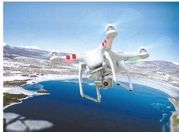
视觉定位系统，内置的视觉和超声波传感器通过感知地面纹理和相对高度让Phantom 3在室内实现精准定点悬停和平稳飞行。视觉定位系统此前在Inspire 1上也出现过，系统通过图像画面与超声波进行一定范围内的定位，解决了室内无卫星信号时的定位问题。但视觉定位系统在Inspire 1的使用反馈并不十分受好评，Phantom 3搭载的视觉定位系统的有效度还需检验。
