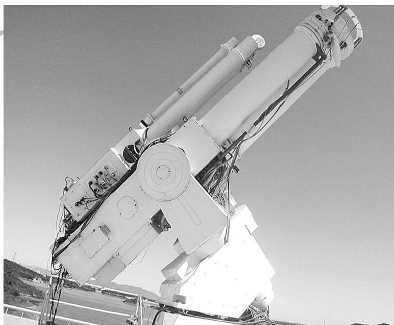
太阳磁场测量设备之多通道望远镜
