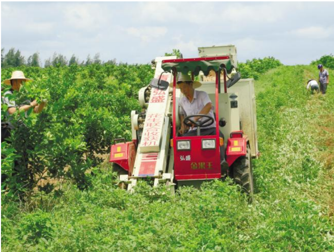
7月6日,在广西合浦县乌家镇“果园间作花生全程机械化高产高效栽培技术试验示范区”,一场花生联合收获机现场作业展示,让前来观摩的广西专家、企业家和农户开了眼界。据介绍,在过去,收花生是个辛苦活,一个人一天下来也只能收0.3亩左右。现在,有了花生联合收获机,每小时就可收获2亩,是人工收获效率的50多倍。 本报记者贺根生摄影报道
