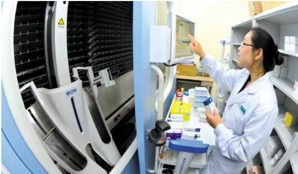
5 月 5 日,河北联合大学附属医院自动化门诊药房的药剂师在调整自动针剂上药机内药品。当日,河北省首个自动化门诊药房在位于唐山市的河北联合大学附属医院正式启用。自动化药房由全自动上药机、智能存储系统、快速发药机三部分组成,实现了上药、出药自动化,提高了药房的工作效率,减少了患者取药的排队等待时间。郑勇摄(新华社供图)
