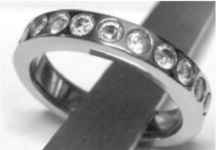
工程师将一个铜线圈安装在了戒指的内部,当戒指处于交变磁场中时,铜线圈即可产生电流,点亮LED灯。
