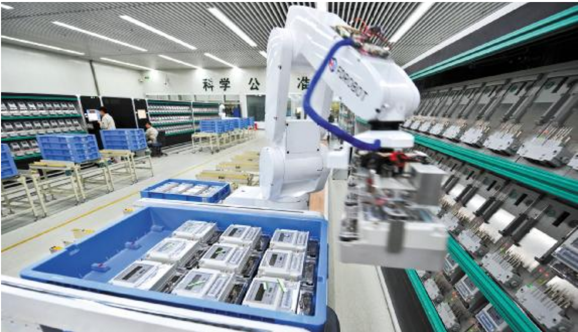
5月20日，一台智能检定机器人在生产线上进行检定作业。当日是“世界计量日”，由国家电网重庆市电力公司电力科学研究院自主开发的电能表柔性自动化检定系统在渝正式投入使用。该系统主要由智能检定机器人、自动检定和自动加封装置构成，其投入使用改变了电能表的检定模式，提高了机器人检定的效率和准确性，同时也有利于消除人为和地域因素引起的检定质量差异。据悉，此次投入使用的电能表柔性自动化检定系统是首期工程，预计今年7月整体技术改造完成后，将有24台新一代机器人替代人工完成重庆计量中心每年200万只的检定量，每年将节省成本200多万元。新华社记者刘潺摄
