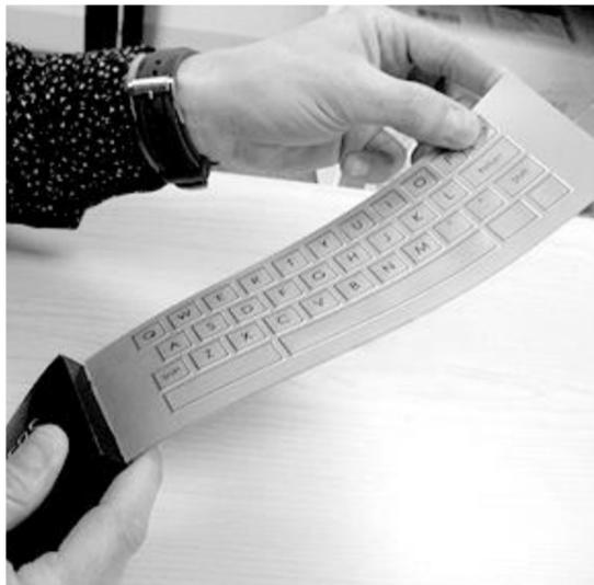
柔性可弯曲键盘的技术特点,是研制出了一种可根据所施加的电场改变形状的聚合物。
