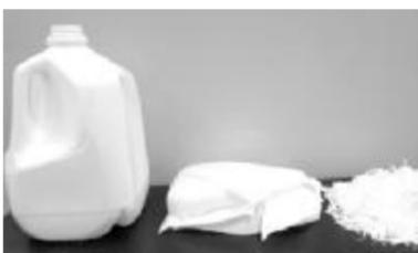
利用塑料瓶来制造3D打印“墨水”,一方面将解决它们所带来的环境问题,另一方面也将大大降低3D打印的成本。
