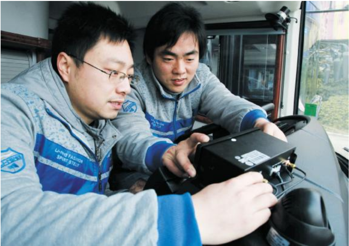
1 月 29 日，技术人员在合肥骆岗机场停车场对“北斗巴士”的卫星定位汽车行驶记录仪进行维护。安徽省首批安装北斗卫星导航系统的客运巴士日前正式投入使用。据了解，第一批“北斗巴士”采用北斗和 GPS 双模芯片，同时接收北斗系统和 GPS 系统的定位数据。这些车辆将用于合肥市内至合肥新桥国际机场的旅客运输。
