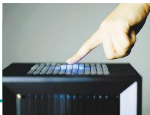
美国麻省理工学院媒体实验室触摸媒体小组开发的“inFORM”动态显示器。
