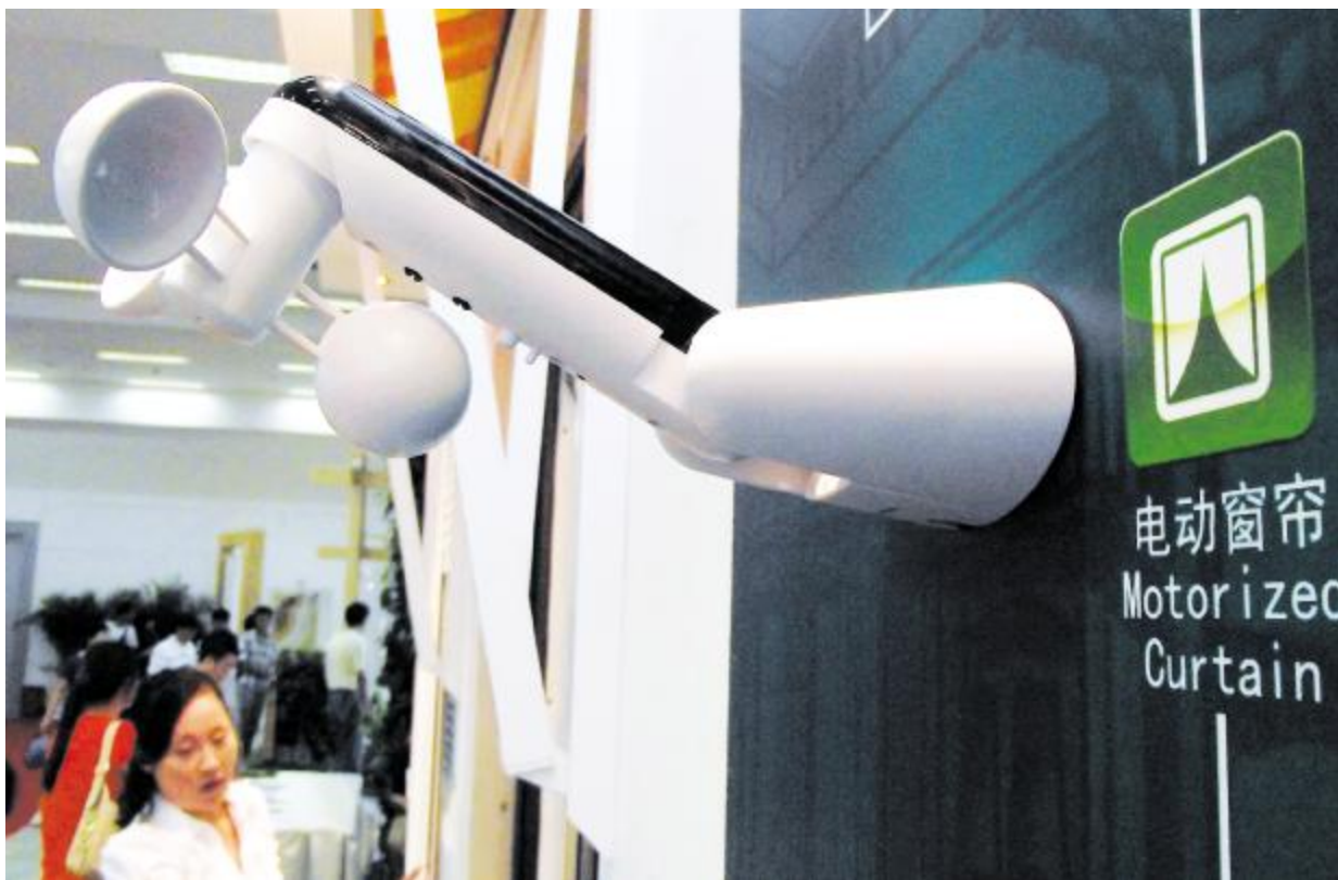
9月2日,一套被誉为“聪明房”的智能家居系统在江苏省南京市规划展览馆亮相。该系统由浙江宁波一家机电企业技术人员研制,应用物联网和绿色建筑技术,可借助小型传感器对户外风、光、雨等天气指标进行收集和分析,或按照智能电脑终端预设程序,适时控制家居电动门窗、室内空调和灯光照明等设施的开关。图为智能家居系统重要部件传感器模型。 CFP 供图
