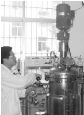
▲用于生产工具酶的发酵装置 图片来源:福建南生科技有限公司
