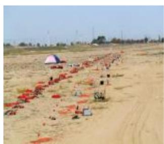
无缆自定位地震探测系统阵列
