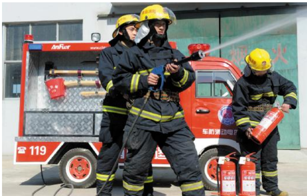
近日,一种微型电动消防巡逻车在青岛研制成功。该产品能满足城乡狭窄区域初期火灾救援,以及4A级以上景区消防装备驻守等需要。该车长约4米,高约2米,纯电力驱动,配有大容量水箱和大功率高压水泵、干粉及泡沫灭火器,还配有消防斧、消防扳手、消防铲、撬棒等消防工具。
